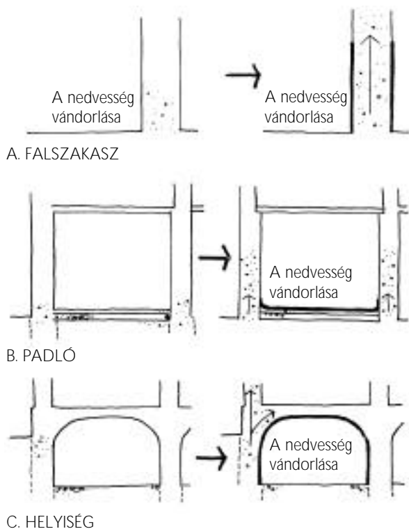
8. ábra Ábrásorozat egy rosszul értelmezett szigetelőrétegről
